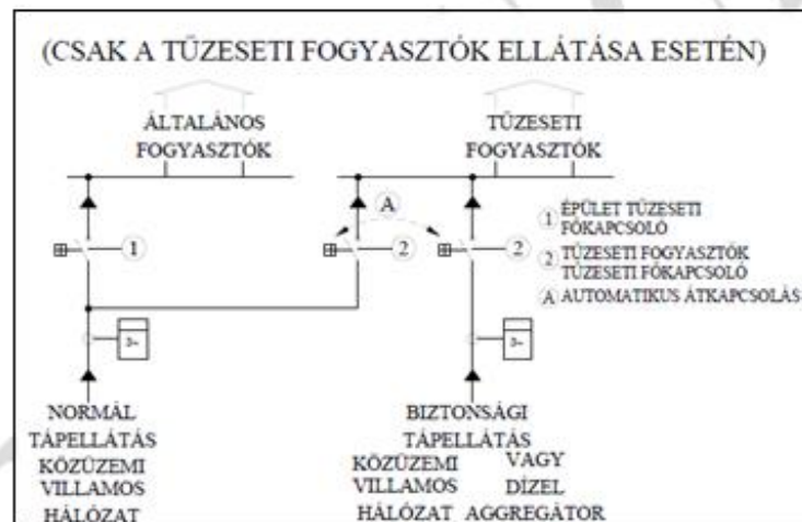
7. ábra Tüzeseti fogyasztók ellátás kettős biztonságú betáplálással „B”
