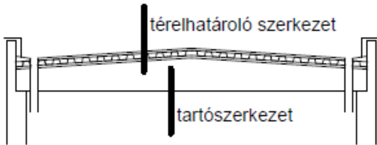
9. Tetőfödém tartószerkezete és térelhatároló szerkezet
